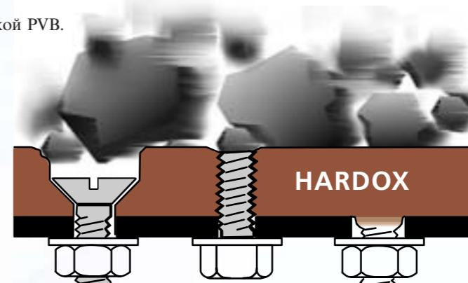
Приварка крепежных элементов обеспечивает более высокую надежность чем ввинчивание винтов или болтов с потайной головкой в резьбовое отверстие.
