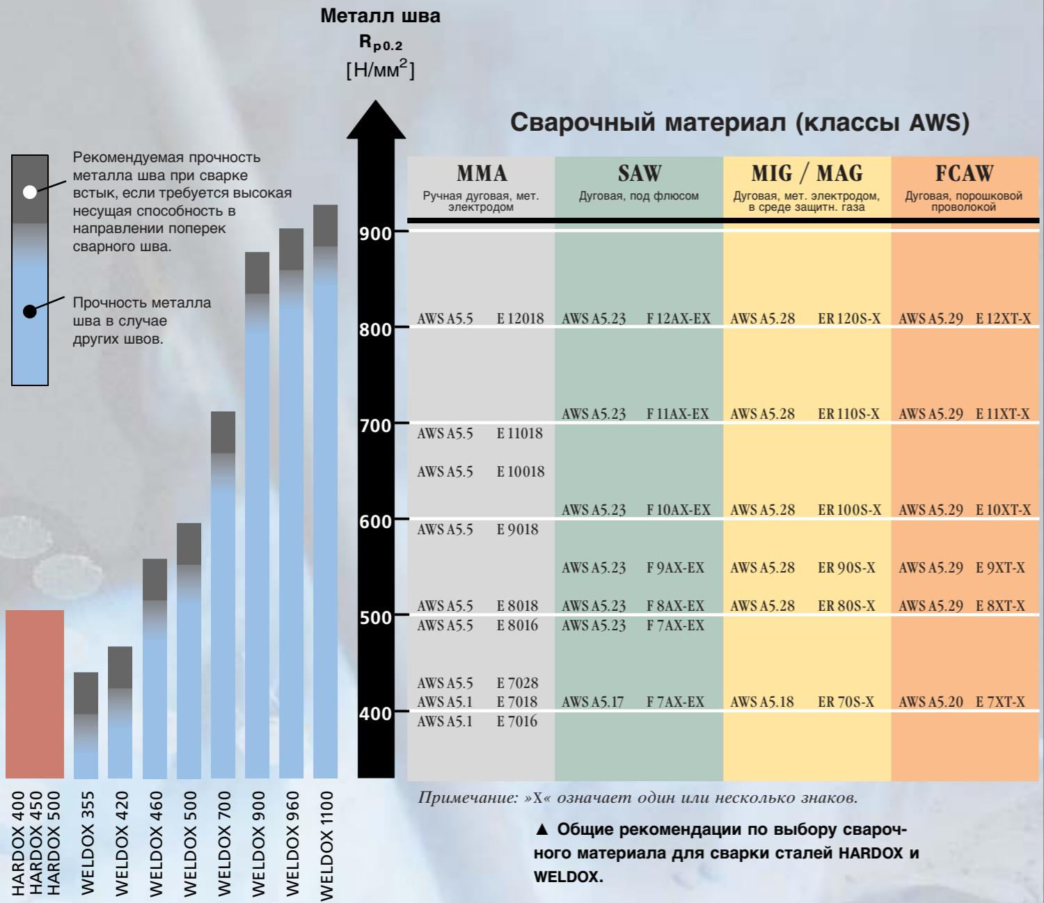
▲ Общие рекомендации по выбору сварочного материала для сварки сталей HARDOX и WELDOX.
