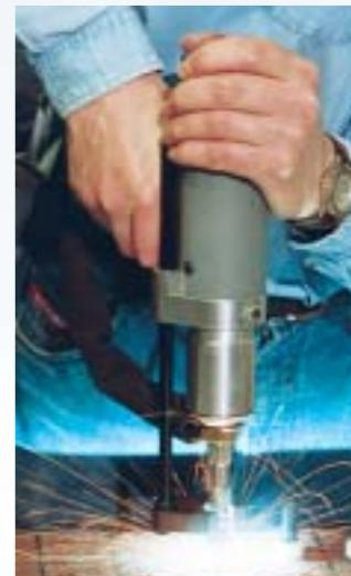
Сварка является быстрым и экономичным способом крепления болтов, винтов, шпилек и подобных элементов к металлическим поверхностям. Сварка часто позволяет исключить дорогостоящую механическую обработку, например сверление, зенковку и нарезку резьбы. Процедура сварки проще чем традиционные методы, ее может выполнять даже не обученный сварщик.
